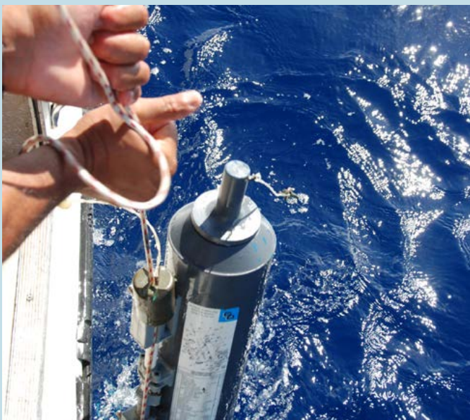
Prélèvement d'eau de mer avec une bouteille Niskin™ © Hocd R., IRD
